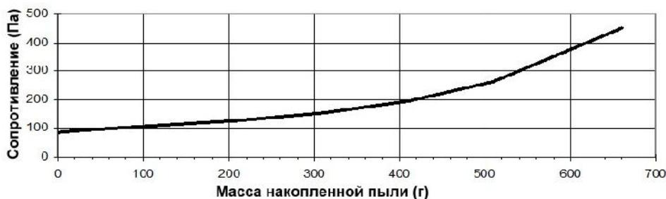
Рис. 2. Зависимость сопротивления воздушного фильтра от количества накопленной им пыли (расход воздуха 0,94 м<sup>3</sup>/с)
