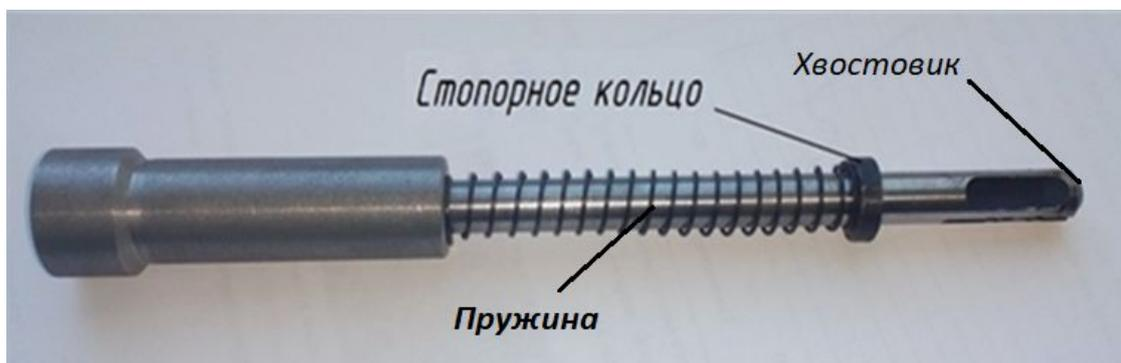
Рис. 4. Приспособление с установленным кольцом
