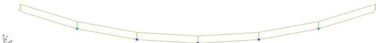
Рис. 4. Перемещение ванта по оси Z составила в центре 0,528 (м)
